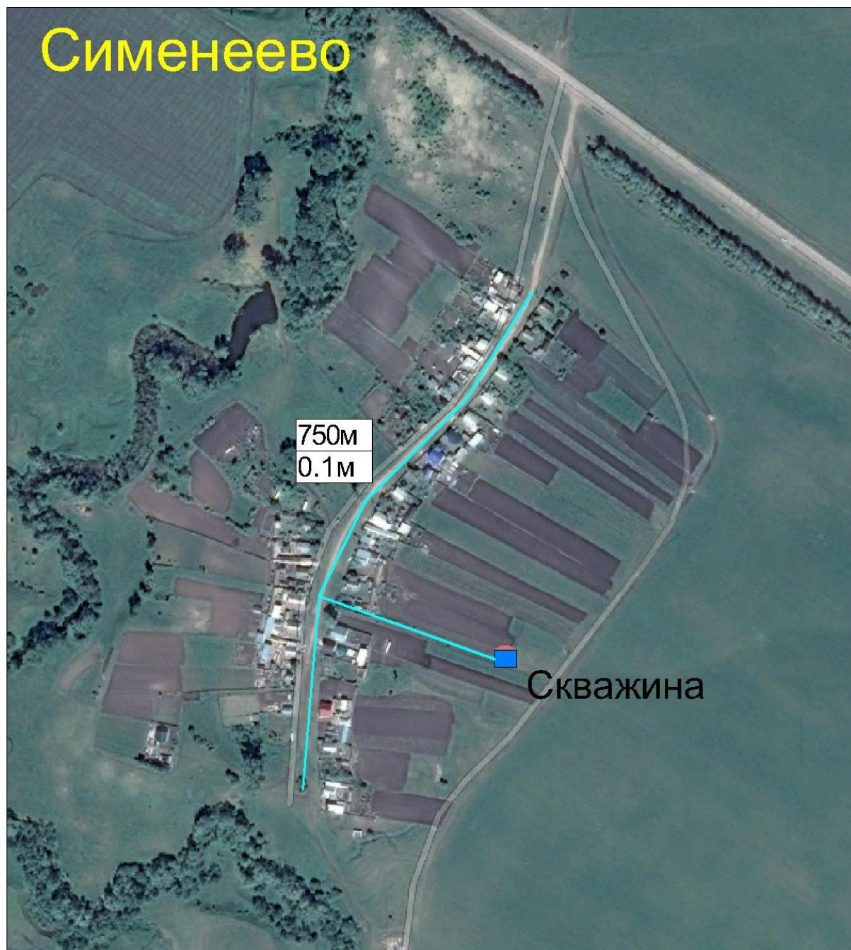
Рисунок 1-5. Зона централизованного водоснабжения н.п. Сименеево
