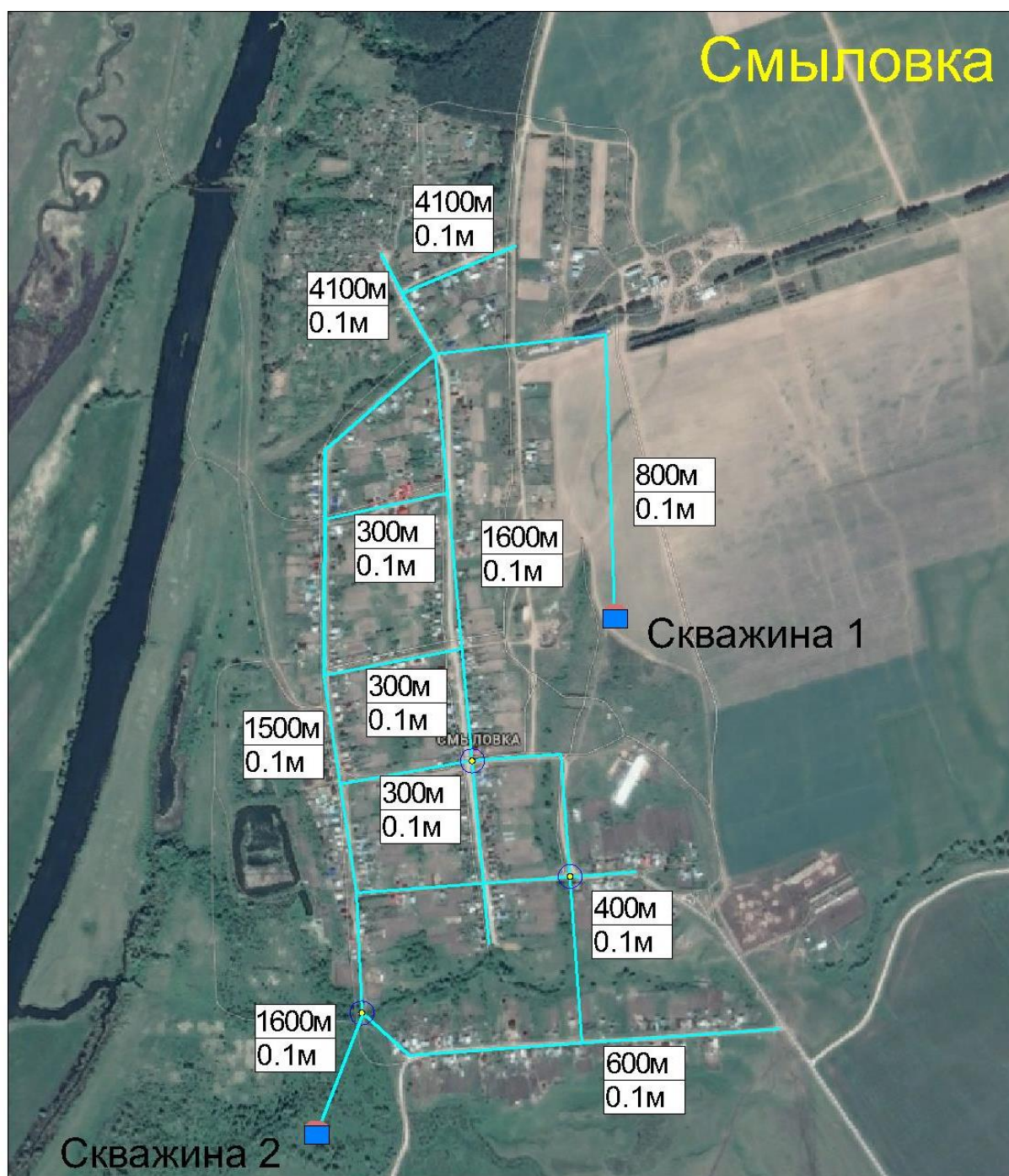
Рисунок 1-4. Зона централизованного водоснабжения н.п. Смыловка
